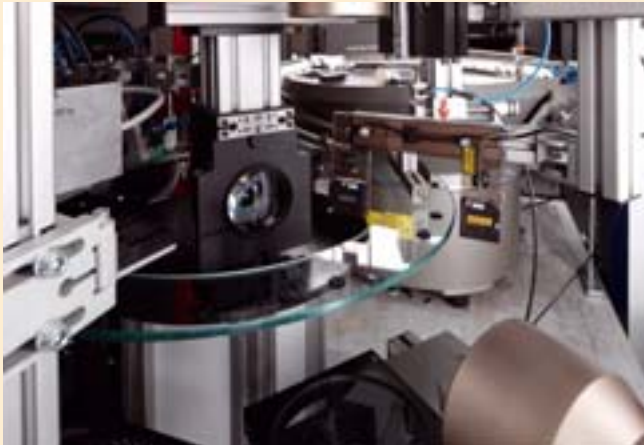
Ein Gestell der visiSort-T führt die Prüfteile den Kamera-stationen zu.
