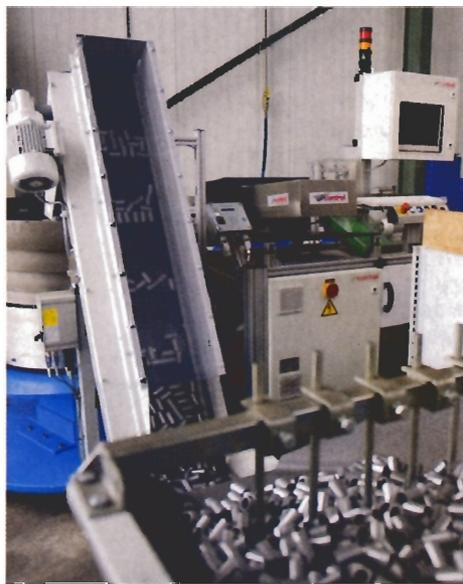
**ThyssenKrupp Materials International produziert am Standort Bühl mit 25 Mitarbeitern auf 8 Sägeautomaten zumeist im 2-Schichtbetrieb jährlich rund 20 Millionen zum Teil mit engsten Toleranzen versehene Rohrabschnitte aus Stahl und Edelstahl für Anwendungen in der Automotive-Industrie und anderen Serienbedarfsfällen.**
