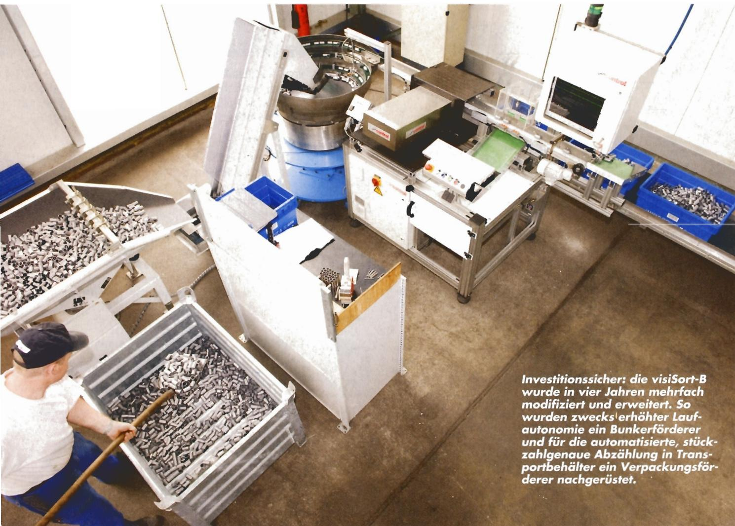
*Investitionssicher: die visiSort-B wurde in vier Jahren mehrfach modifiziert und erweitert. So wurden zwecks erhöhter Laufautonomie ein Bunkerförderer und für die automatisierte, stückzahlgenaue Abzählung in Transportbehälter ein Verpackungsförderer nachgerüstet.*
