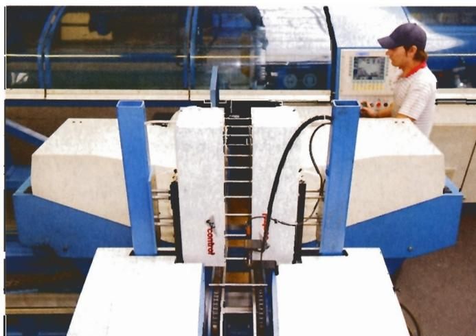
**Coming soon: Für die flexible, schnelle und präzise in-process-Messung von Länge und Durchmesser hat visicontrol bei ThyssenKrupp Materials International in Bühl jüngst an einer der 8 CNC-gesteuerten Hochleistungs-Sägeautomaten ein BV-System mit 2 Kameras integriert. Weitere Nachrüstungen sollen folgen. (Bild: visicontrol/Hennecke)**
