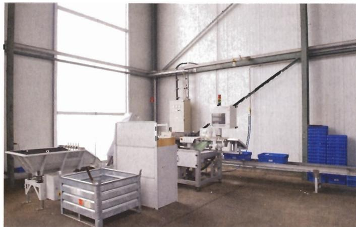
**Die bei ThyssenKrupp Materials International in Bühl installierte visiSort-B arbeitet zumeist 2-schichtig und prüft derzeit Rohrabchnitte bis 140 mm Länge, respektive bis maximal 35 mm Durchmesser mit einem Durchsatz der bei den kleinsten Teilen bis zu 120 Stück/Minute erreicht.**
