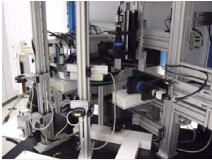
Bild 2: Innenansicht einer visiSort-T die für 17 Teiltypen ausgelegt ist und entsprechende Wechsel-elemente aufweist.
