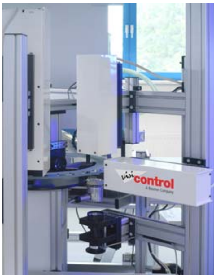
Bild 1: Beispiel der Auslegung einer Inspektionsanlage für einen einzigen Teiletyp für 300 Teile pro Minute. Gestellanlage visiSort-T.
