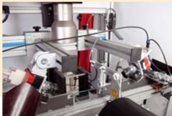
An einer Kamerastation werden mit zwei telezentrischen, optischen Systemen die Maße hochaufgelöst vermessen und präzise mit Toleranzen verglichen. Zusätzlich zwei attributive Kameras.
